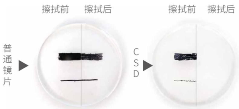
可以发现CSD镜片更容易擦拭,几乎没有留下痕迹。优秀的疏油性使得油垢在镜片上不易附着,有效减少了污渍的困扰,不用再担心皮肤分泌的油脂、指纹、空气中的灰尘让眼前一片模糊。较强的清洁能力让视野更清晰,带来不一样的感官体验。
